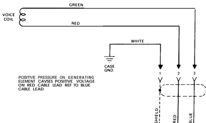
FIGURE 3 -Wiring Diagram
